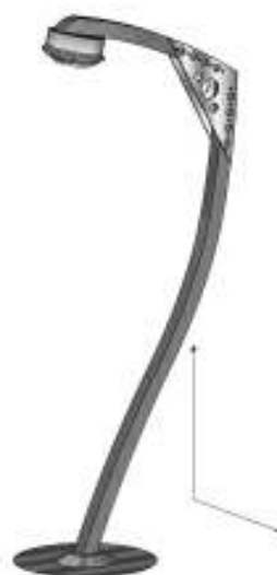
Latarnia ogrodowa – słup i ramię gięte z wiazu klejonego warstwowo, wzmocnienia, podstawa i oprawa reflektora ze stali nierdzewnej
