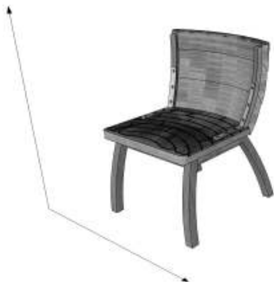
Krzesełko ogrodowe – oparcie z giętej klepki dębowej, klepki siedziska z drewna teakowego, nogi z wiazu
