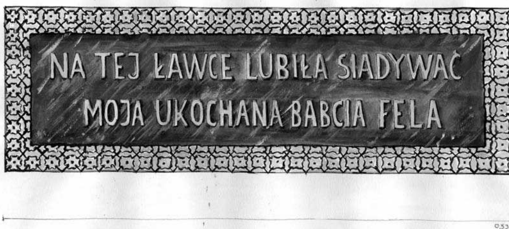
detal - tabliczka: na przezroczystym szkłe napis biały, oprawa - blacha, ażur cięty laserem.
